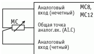
Рисунок 11 – Схема подключения, рекомендуемая для проверки аналоговых входов для сигналов ТС 50М, 100М, 50П, 100П, 100Н и реостатного датчика 100 Ом (3-х проводное подключение)
