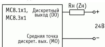
Рисунок 16 – Схема подключения для проверки дискретных выходов МС8.1х1 и МС8.3х1
