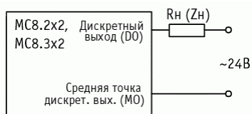
Рисунок 17 – Схема подключения для проверки дискретных выходов МС8.2х2 и МС8.3х2
