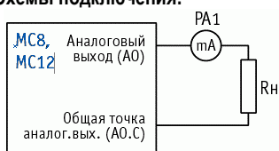
Рисунок 13 – Схема подключения для проверки аналоговых выходов по току
