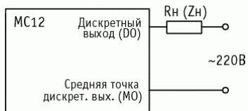
Рисунок 18 – Схема подключения для проверки дискретных выходов MC12
