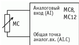
Рисунок 10 – Схема подключения для проверки аналоговых входов для сигналов ТС, термисторов и реостатных датчиков (2-х проводное подключение)
