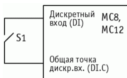
Рисунок 12 – Схема подключения для проверки дискретных входов
